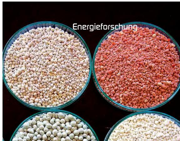
Sorptive Wärmespeicher sind poröse Granulate mit einer sehr großen inneren Oberfläche (ein Gramm hat eine innere Oberfläche von etwa 600 m<sup>2</sup>). Sie haben die Eigenschaft, Wasserdampf anzuziehen und an ihrer Oberfläche anzulagern. Dabei wird Wärme frei. Um sie wieder „aufzuladen“, muss man sie trocknen.
