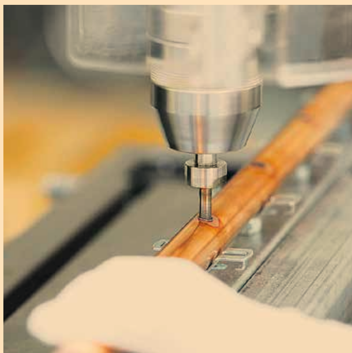
Urbane Produktion in der Seestadt: Herstellung eines thermischen Absorbers für Sonnenkollektoren.
