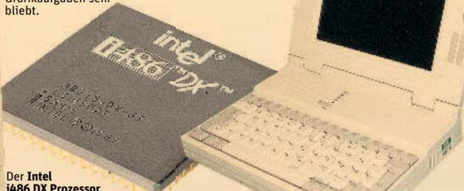
Der **Intel i486 DX Prozessor** packte erstmals über eine Million Transistoren auf einen Chip und war multitaskingfähig. Erste PCs mit dem Chip kosteten rund 6000 Dollar.
