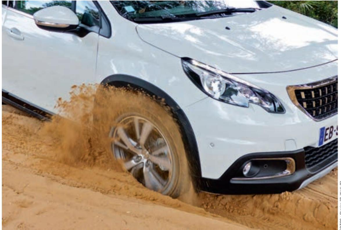
Die Verfeinerung der Schlupfregelung sorgt für kontrolliertes Durchdrehen und kann mitunter sogar Allradantrieb ersetzen.
